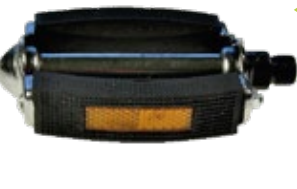
PD 142002 PEDAŁY METALOWO-GUMOWE WYMIARY 125X70 MM, ŁOŻYSKA KULKOWE, ŚWIATŁA ODBŁASKOWE WPUSZCZONE, ROZBIERALNE
