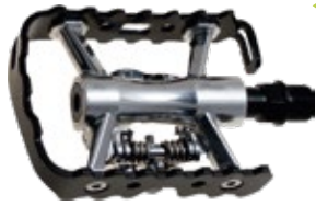
PEDAŁY WP-MD201 PEDAŁY MTB ALUMINIOWE NA ŁOŻYSKACH MASZYNOWYCH L.SL Z JEDNOSTRONNYM ZACZEPEM SPD. OŚ CR-MO, ROZMIAR 105X66, WAGA 183 G/PARA
